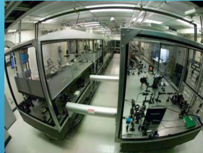
MERCURY (LLNL) DPPSL lézer \lambda = 351 \text{ nm} dióda pumpált szilárdtest lézer
